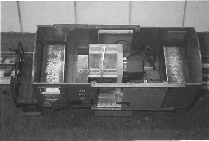
Herman-J. Goebels: Ein Blick von oben in den Arbeitswagen. Deutlich ist der eingebaute Schwingschleifer zu erkennen.
