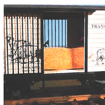
LGB 42362: Die Geräuschelektronik des Schafwagens ist unter »Heu« versteckt.
