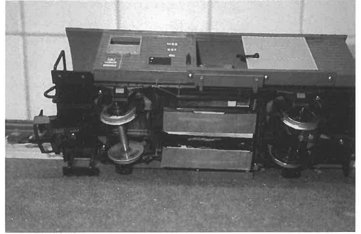
Herman-J. Göbels: Blick auf die unterhalb des Wagens angebrachten Schleifstücke des Schwingschleifers.
